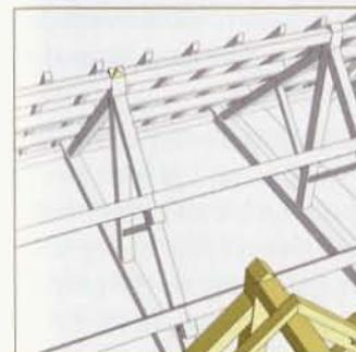
2. Pour assurer le raccordement du plan de l'extension et des chevrons de noue, la tête du poinçon reçoit une petite pièce (de forme pyramidale) qui permet d'asseoir la noue.
