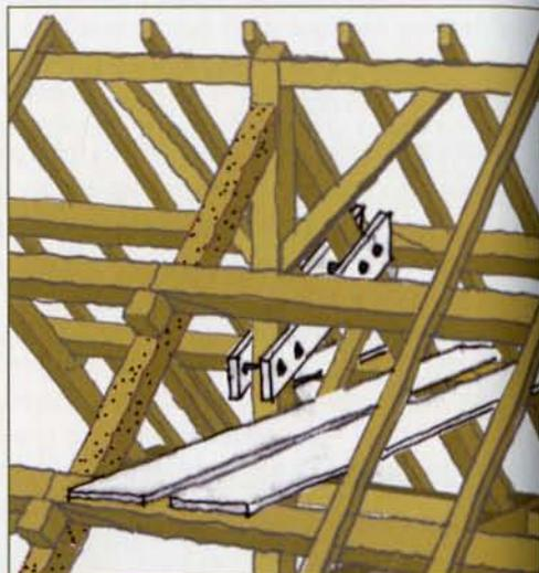
2. On reconstitue le triangle indéformable de la ferme à l'aide d'une pièce moisée reliant le poinçon à l'autre arbalétrier.
