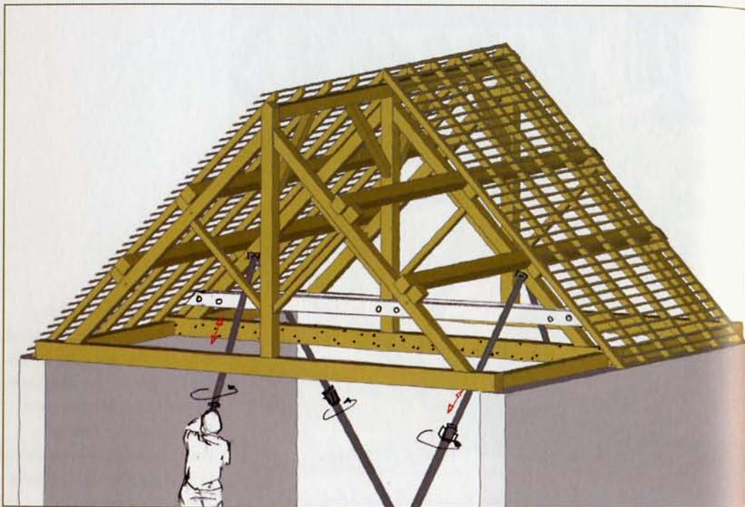
1. On remplace ici l'entrait de la 2<sup>e</sup> ferme. Les arbalétriers sont tout d'abord étayés à l'aide de vérins. Ceux-ci sont placés au droit des pannes médianes, et prennent appui sur les solives du plancher inférieur.
