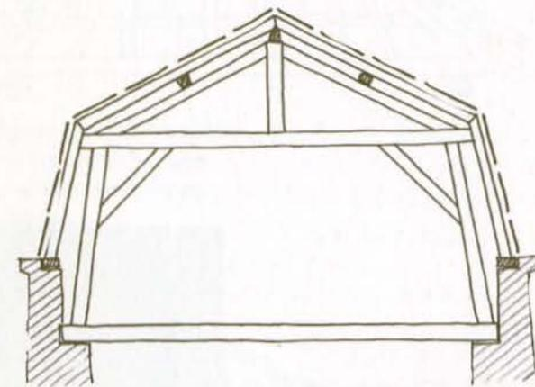
L'usage d'une charpente «à la Mansard» a permis l'utilisation optimale du volume des combles de cette maison normande.
