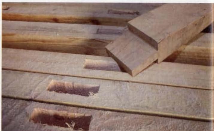
*À l'aide de la mortaiseuse, le charpentier creuse les mortaises qui accueilleront, ultérieurement, des tenons.*
