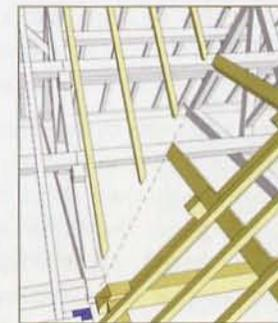
3. On peut alors raccorder les deux plans de toiture en creux, formant ainsi une noue chanlattée.
