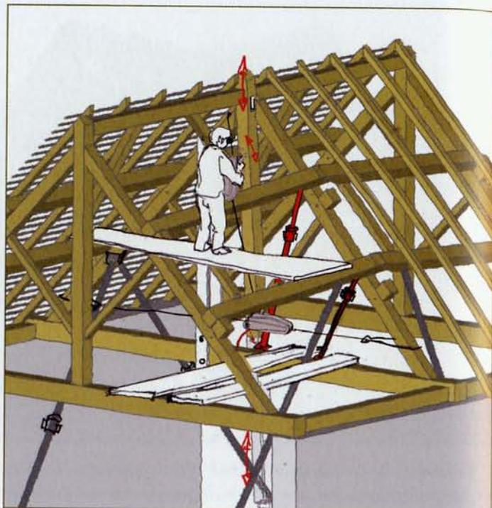
7. On peut dégager le poinçon en le débitant, par le haut, de son tenon de pied et le basculer sur le côté de l'entrait en le laissant maintenant glisser vers le bas.
