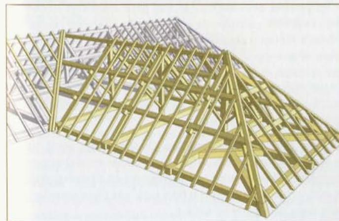
4. Les pannes de la nouvelle charpente viennent prendre appui sur celles du bâtiment initial. Les empançons sont fixés sur la noue, formée de deux pièces définissant un angle rentrant.
