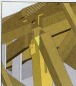
8. Une mortaise est créée aux deux bouts des pannes faitières sciées. On met en place le nouveau poinçon, qui s'assemble au faitage grâce à 2 faux tenons qui seront chevillés. C'est le même Tirfor® qui sert à ce réemboîtement.
