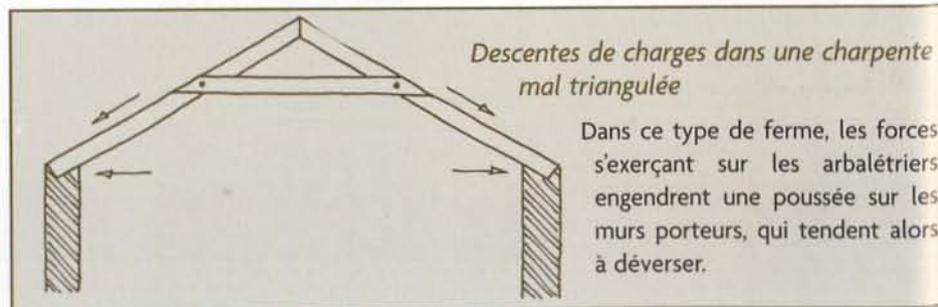
Descentes de charges dans une charpente mal triangulée
