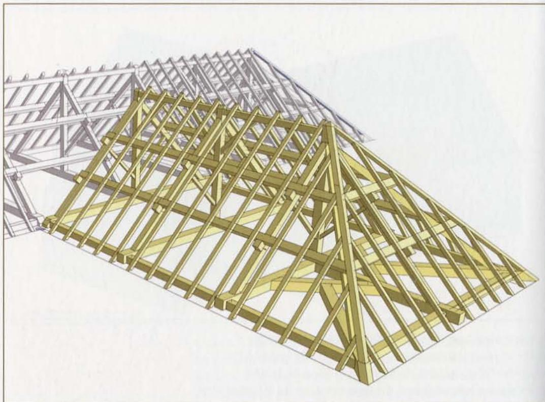
1. L'extension projetée se situe en partie centrale de la charpente existante et comportera une croupe. On commence par découvrir les travées où se greffera l'extension. On monte ensuite le nouveau corps de bâtiment, dans l'axe de la ferme centrale.
