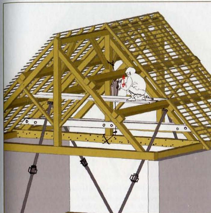
2. À l'aide d'un Tirfor®, on fait soutenir l'entrait sur lequel on intervient par le haut du poinçon.
