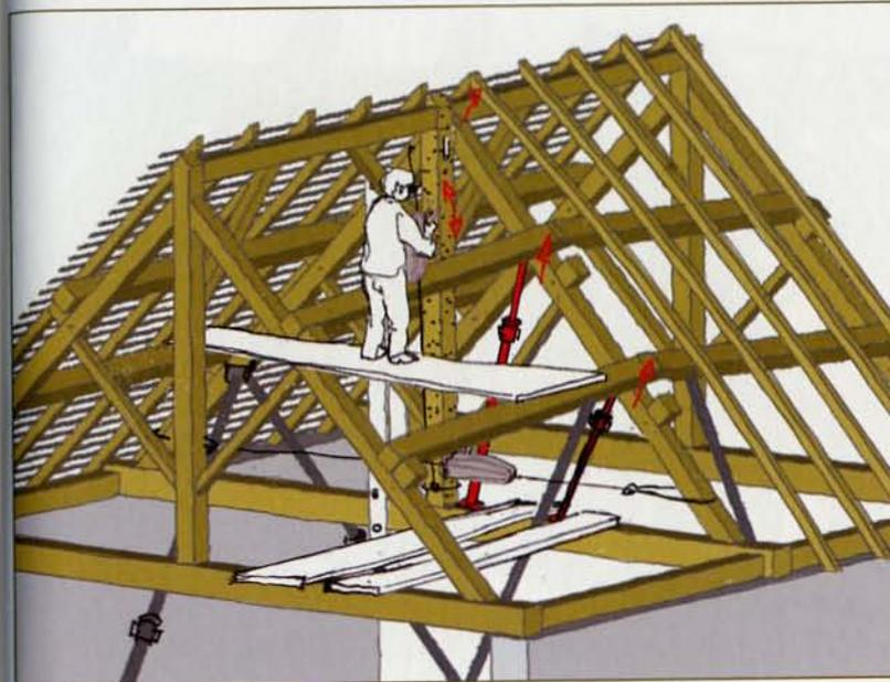
4. On décheville la tête de l'arbalétrier moisé. On peut alors soulever les pannes. Le poinçon est attaché à l'arbalétrier moisé à l'aide d'un Tirfor® qui reste en place.
