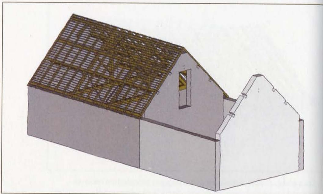
1. On a choisi pour cette maison d'augmenter la surface habitable en prolongeant le bâtiment initial. Le nouveau volume étant modeste, une seule ferme de charpente est nécessaire. On commence par élever le nouveau pignon, l'emplacement des pannes de la future charpente étant déjà déterminé dans la maçonnerie.
