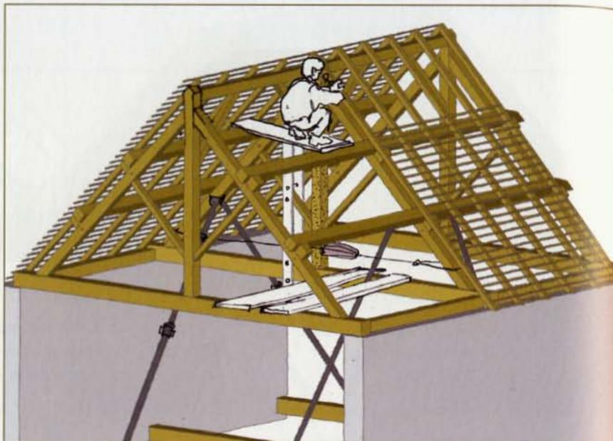
1. On remplace ici le poinçon de la 2<sup>e</sup> ferme. On commence par installer un Tirfor® en pied entre les deux arbalétriers et on moise ensuite la demi-ferme qui semble la plus solide en liaisonnant arbalétrier, contrefiche et entrain. Des vérins sont placés sous l'arbalétrier moisé, au niveau de la contrefiche, et sous les pannes du côté opposé.
