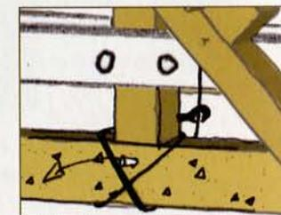
3. On désassemble l'entrait et le poinçon...
